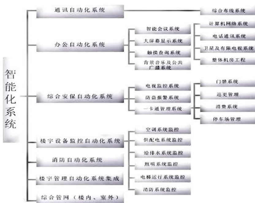
图1 建筑智能化系统
