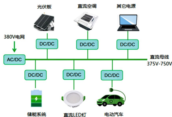
图1 光储直柔微电网架构图
