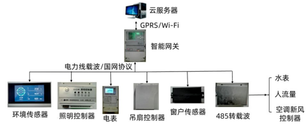
图3 硬件系统架构
